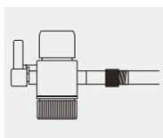
3. 將水龍頭的起波器取下，改安裝分流器(含墊片)，將PE水管的另一端安裝在主機後方的進水口。
