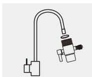
4. 進水管連接進水口時，需先壓住灰色防漏環後，取下防塵塞。再連接2PE管並插入防落夾。
