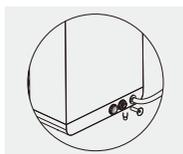
5. 將出水管連接至濃水口並裝上防落夾，並將吸盤貼附至水槽側壁。
