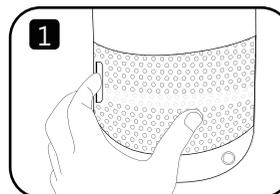
1. 關閉電源並拔掉插頭後，請將產品後方的濾網蓋把手向後拉。
