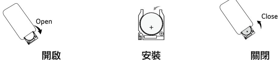
1. 輕按左側壓鈕，同時將電池蓋向下拉動，即可取出電池盒蓋。
