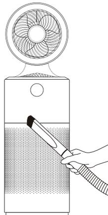
Utilice una aspiradora para eliminar el polvo de la salida y entrada de aire.
