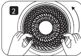
2. Gire la protección del ventilador en sentido contrario a las agujas del reloj y retire la protección.
