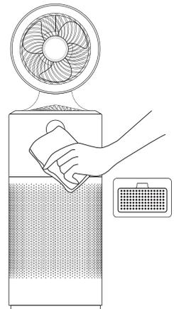
Utilice un paño suave para limpiar el exterior y la cubierta del sensor en la parte posterior del producto.
