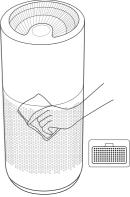
Utilice un paño suave para limpiar el exterior y la cubierta del sensor en la parte posterior del producto.
