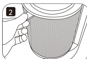
2. フィルターを外し、新品のフィルターと交換します。
