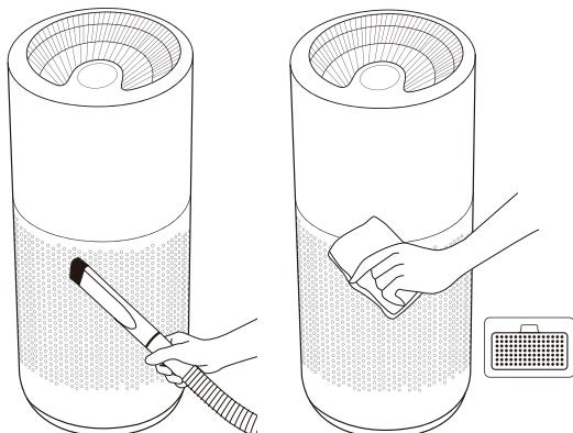
掃除機を使用して空気吹き出し口と空気吸込み口から埃を取り除きます。
