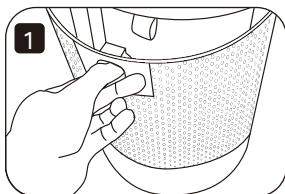
1. 電源をオフにして電源プラグを外した後、製品の背面にあるフィルターカバーのハンドルを引きます。
